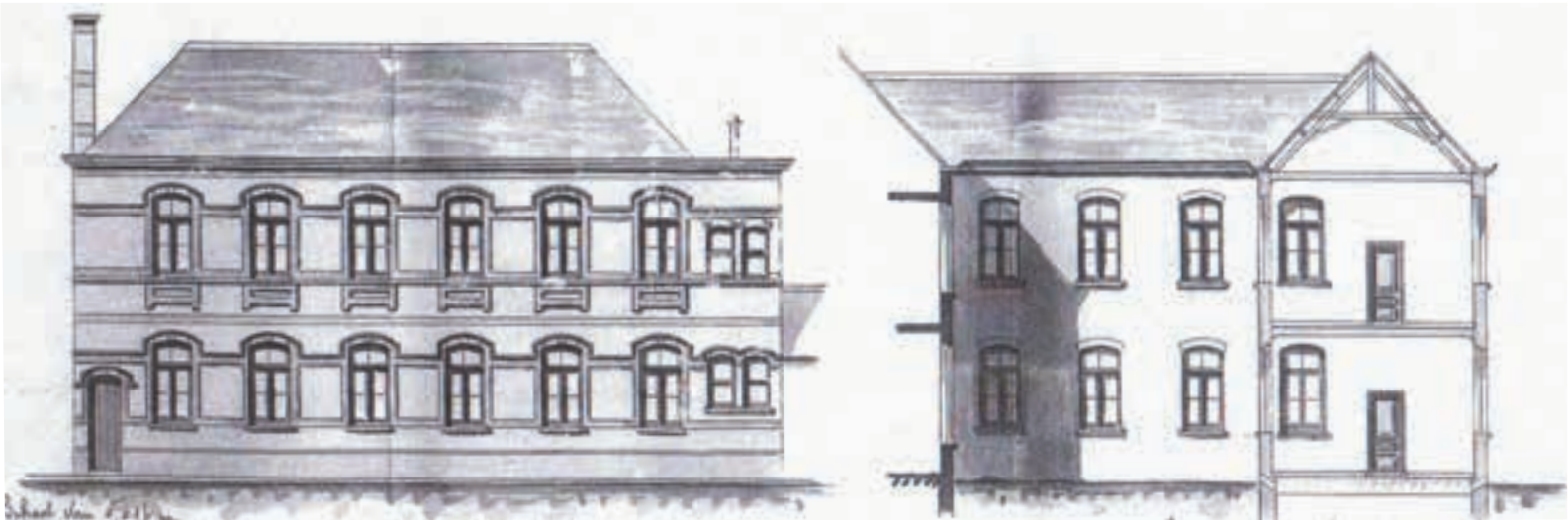
Ontwerptekening door architect Goethals (Rijksarchief Beveren). De vergroting van het mannenverblijf resulteert in een voornaam ogend gebouw langs de Kouterstraat. Op de doorsnedetekening zien we ook de oudere vleugel van het mannenverblijf.
